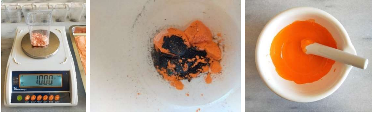
Görüntü 9: 1000°C'lik reçete tartımları ve porselen havanda öğütülmesi. Elçin Telli Ateş kişisel fotoğraf arşivi, 2021.
